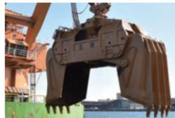
容量200立米、重量370トンの油圧式クレーンは、強力な掴み力があります。自動制御の水平掘り装置で、高精度・高効率浚渫を実現します。(特許)
